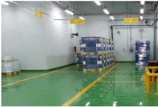
바닥구획선 설치 및 물질별 이격거리 확보
